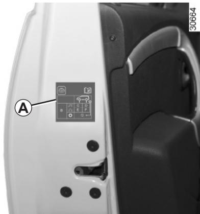
La presión de inflado de los neumáticos está indicada en la etiqueta **A** situada en el canto de la puerta del conductor. Para leerla abra la puerta.
