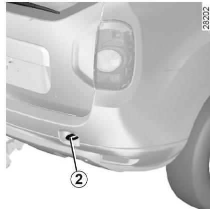
Estos puntos de remolcado tan sólo se pueden emplear para remolcar, en ningún caso deben servir para levantar directa o indirectamente el vehículo.
