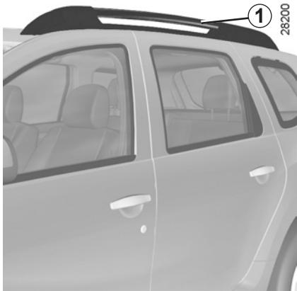
Si el vehículo está equipado con estas barras, se pueden transportar equipajes o accesorios adicionales (portabicicletas, etc.) en unas barras de techo transversales fijadas en las barras de techo longitudinales **1** o directamente sobre estas últimas.
