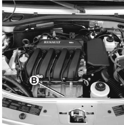
Las indicaciones que figuran en la placa del constructor **B** deberán figurar en todas sus cartas o pedidos. (emplazamiento diferente según motorización)
